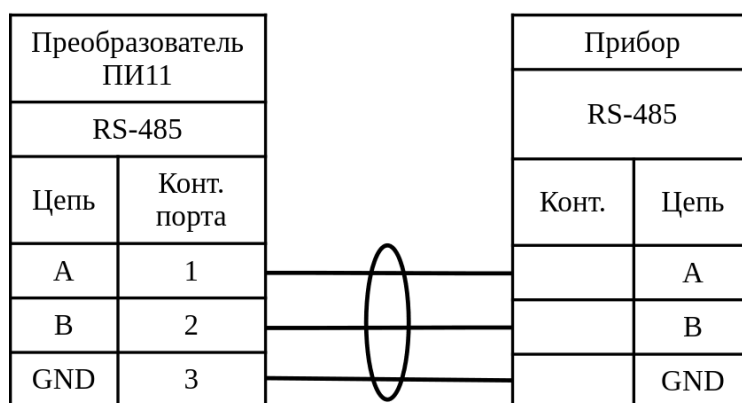
Рисунок 3 – Подключение приборов по интерфейсу RS-485
